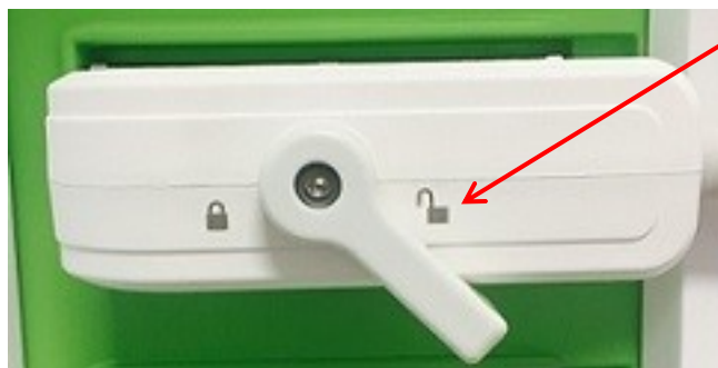
Εικόνα 9: Ξεκλειδωτός επιλογέας ασφάλισης συνδέσμου ηχοβολέα
