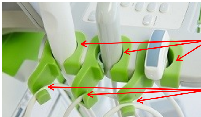
Εικόνα 13: Θήκες ηχοβολέων/γέλης και οδηγοί καλωδίων
